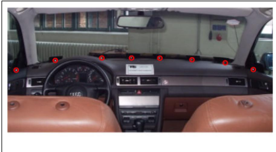
Abbildung 3: Die im Cockpit angeordneten LEDs, im Bild eingekreist
