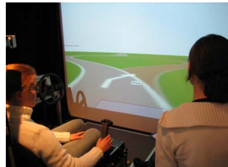
Abbildung 3: H-Mode Prototyp für Straßenfahrzeuge (DLR)
