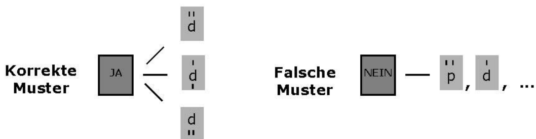
Abbildung 2: D2-Drive als Sekundäraufgabe zur Messung visueller Ablenkung
