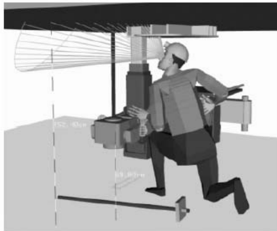
Abbildung 4. Digitales Menschmodell JACK mit Sichtfeld an einem Bergbauarbeitsplatz (aus Bartels, Ambrose & Wang 2001).
